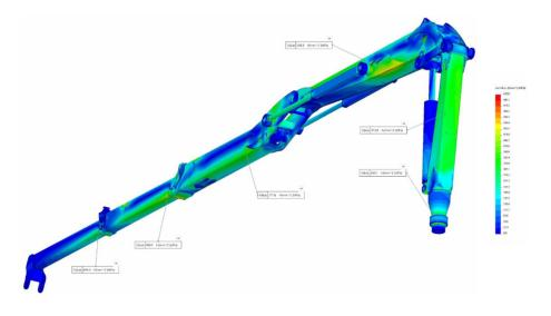
Výsledky pevnostných výpočtov vykonané certifikovanou autoritou potvrdili, že hydraulická ruka ESSEL EC130Z-96 vyhovuje z hľadiska pevnosti aj z hľadiska únavy norme STN EN 12999+A1 a zároveň vyhovela aj požiadavkám smernice európskeho parlamentu 2006/42/ ES o strojových zariadeniach. Pevnostné prepočty simulovali predpokladaný počet 1 milión pracovných cyklov.
