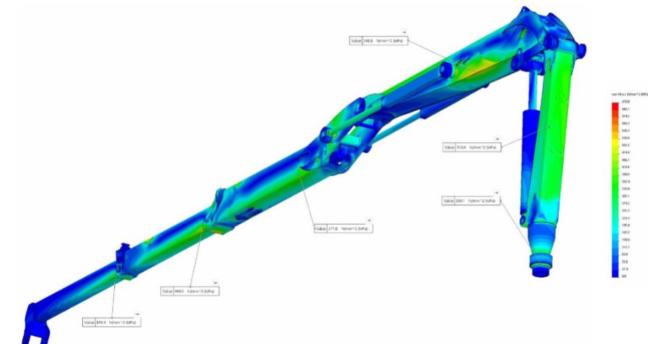
Výsledky pevnostných výpočtov vykonané certifikovanou autoritou potvrdili, že hydraulická ruka ESSEL EC130Z-96 vyhovuje z hľadiska pevnosti aj z hľadiska únavy norme STN EN 12999+A1 a zároveň vyhovela aj požiadavkám smernice európskeho parlamentu 2006/42/ES o strojových zariadeniach. Pevnostné prepočty simulovali predpokladaný počet 600.000 pracovných cyklov.
